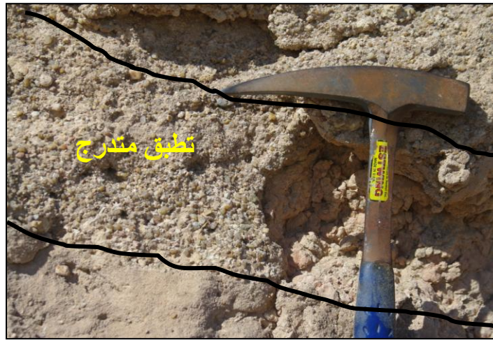
صورة رقم 3: صورة حقلية لطبقة الكونجلوميرات توضح وجود التطبيق المتدرج ضمن الجزء السفلي.
